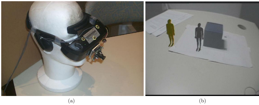
Fig. A.7: Le prototype de casque vidéo (a) et une vue de l'image perceptible à travers (b).
