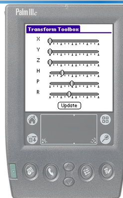
Fig. 7.18: Interaction à partir d'un autre référentiel : interaction par PDA pour le contrôle de l'orientation du contenu d'un tangible AR document à l'aide de sliders.
