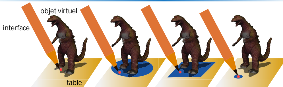
Fig. 6.13: Tâche 2D : représentation des différents types de manipulateurs 2D (ombres, ombres symboliques ou autre formes).
