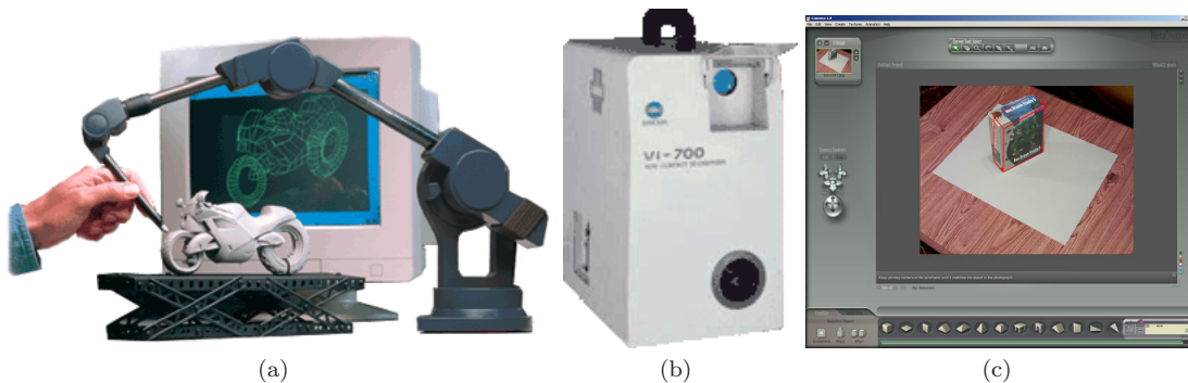
Fig. 5.21: Trois approches pour la digitalisation d'objets réels : (a) manuelle (b) automatique (c) et semi-automatique (logiciel Canoma [Can]).
