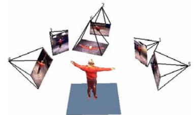
Figure 13: Position de six caméras servant à la construction du modèle 3D et au “texturage”.
