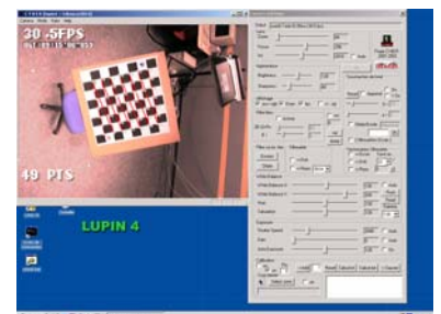
Figure 4: Application permettant de piloter les caméras (focale, diaphragme...) et de calculer les matrices de calibrage.
