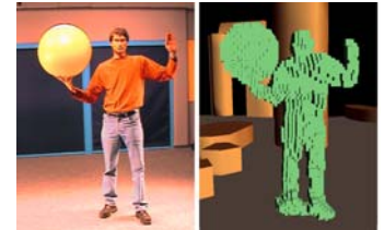
Figure 7: À gauche : vue prise par une des quatre caméras. À droite : reconstruction voxelique.
